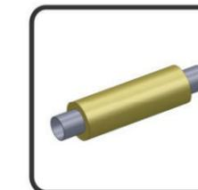
Устройство разгрузочной плиты для бесканальной прокладки труб в ППМ изоляции под проездами
